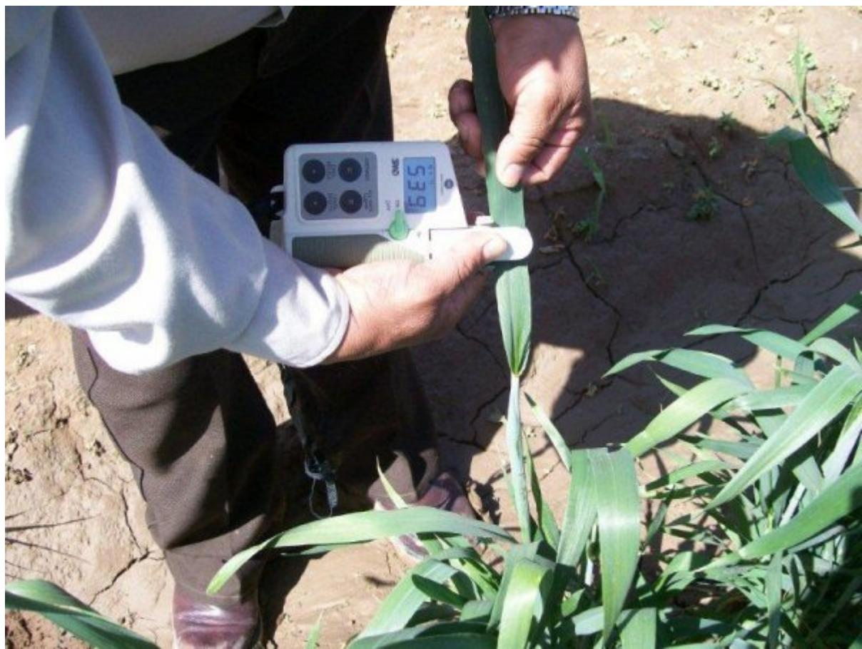
**Toma de lecturas con SPAD 502, para determinar contenido de clorofila en trigo.**
