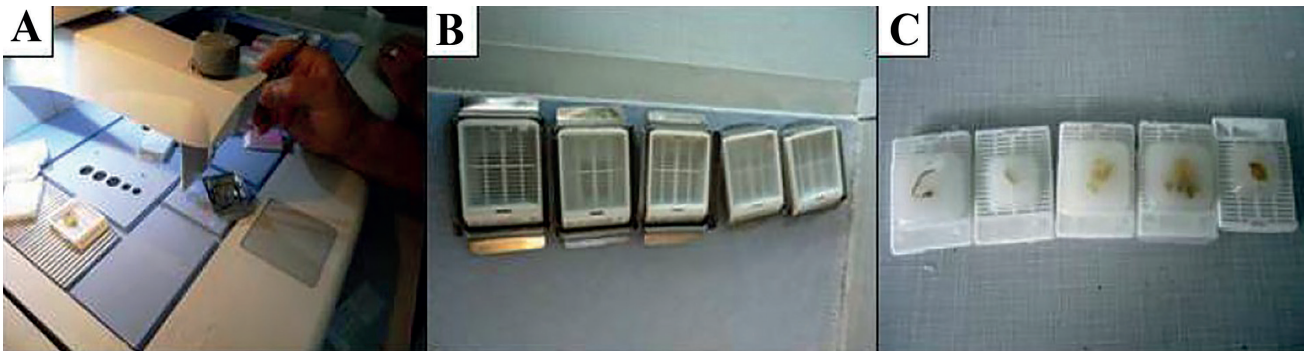
Figura 3. Dispensador de parafina (A) (Thermo SCIENTIFIC, Histo Star), (B) bloques de parafina enfriándose, (C) bloques de parafina con tejido embrionario
