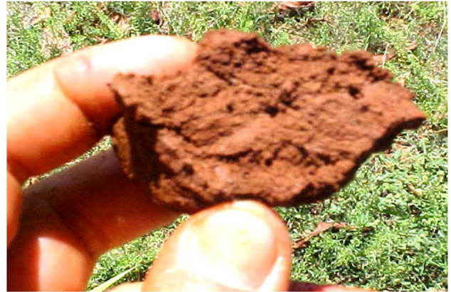
Foto 4. Estructura de bloque angular. Horizonte Bt, suelo Ferralítico Rojo Lixiviado. San José de las Lajas, Mayabeque, Cuba
