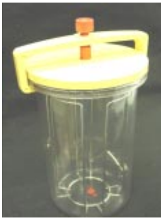
Figura 1. Cámara de CO 2 o Gas Pack® en la que se colocaron las esporas para acelerar su germinación
